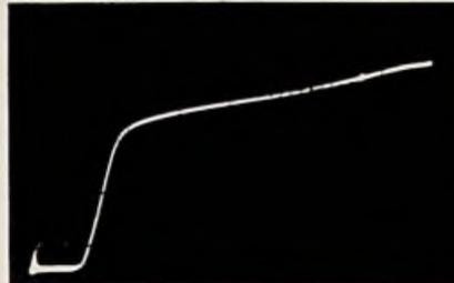
Bild 32. Kennlinie einer Leuchtdiode mit eigener Konstantstromquelle
