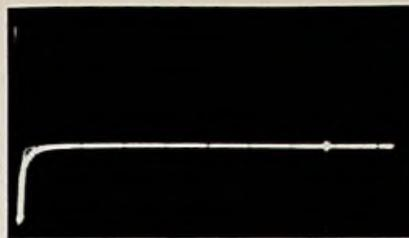
Bild 31. Kennlinie eines Currlistors
